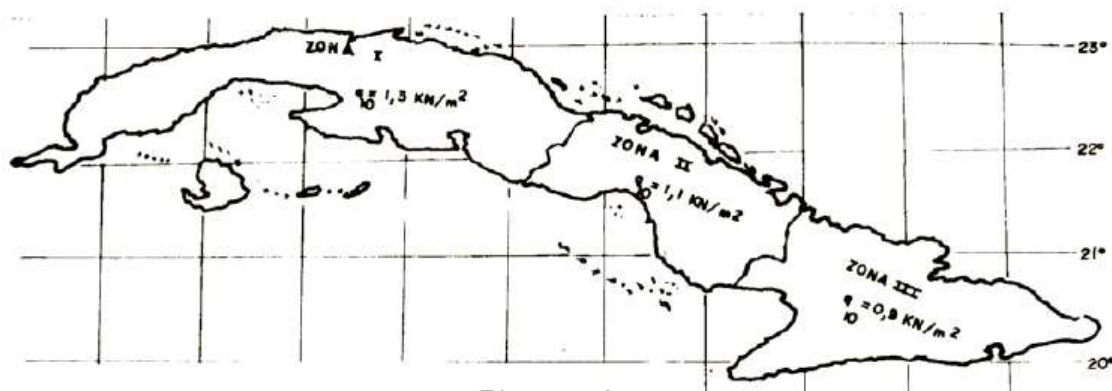
Figura 1 — Regionalización según las presiones básicas del viento
